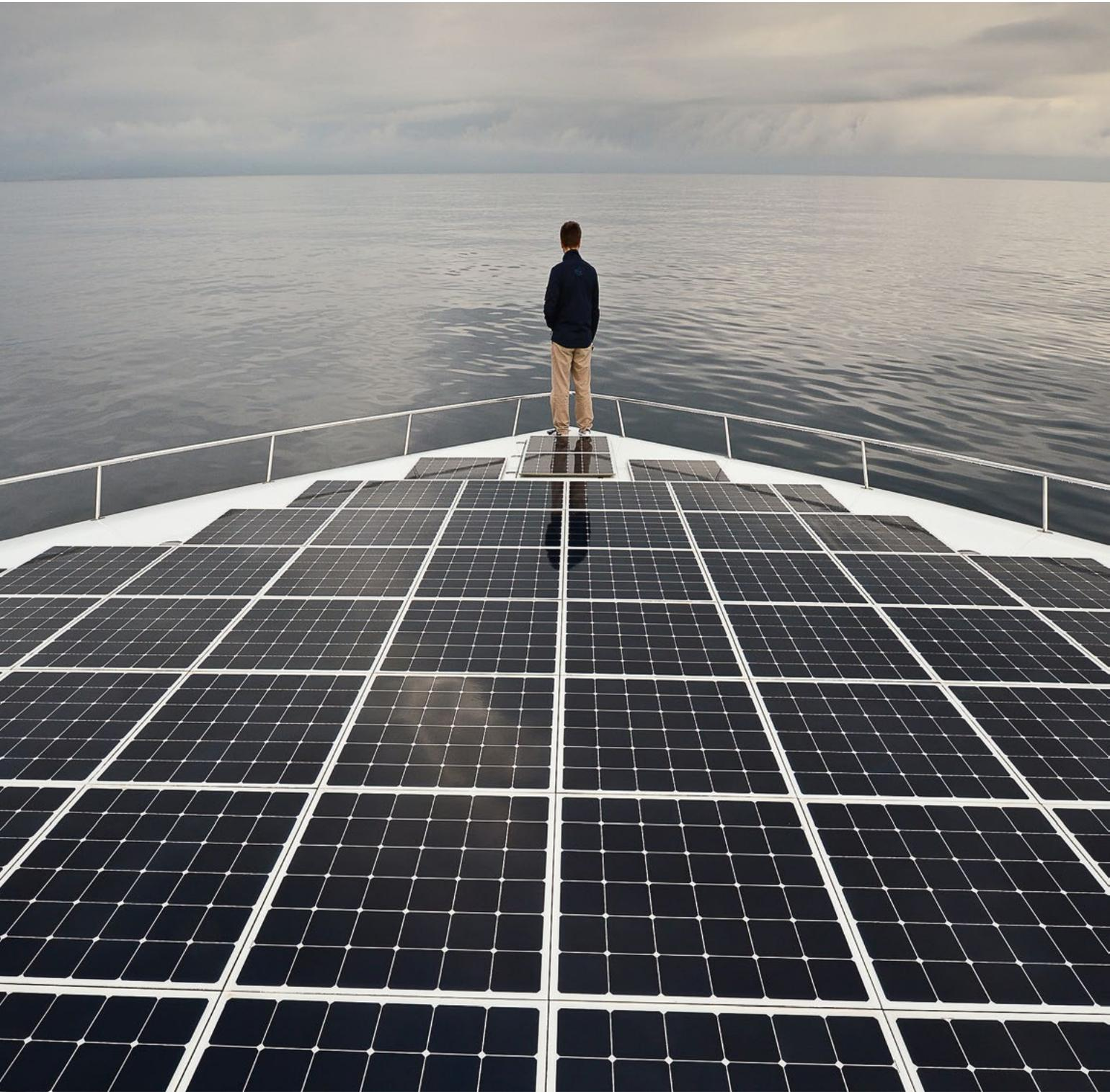
Con sus 537 m<sup>2</sup> de paneles solares y seis bloques de baterías de litio-ion, que permiten una velocidad de navegación récord, *PlanetSolar* es la mayor nave solar que existe y el primer barco que ha dado la vuelta al mundo impulsado por energía solar
